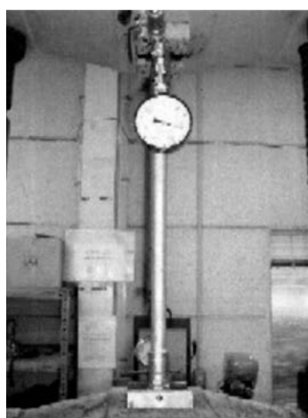
図-4 引抜試験概略図 および 写真
