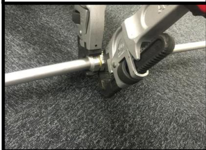
パイプレンチなどの工具で袋ナットを締め付けます。正常に締め付けが完了すると黄色の確認リングが見えなくなります。
