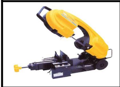
パイプを軸心に対し直角に切断してください。
