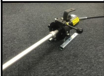
袋ナットを装着し、パイプを工具に確実にセットしてください。
