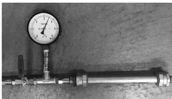
写真－3 水圧破壊試験
