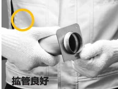
拡管ゲージが拡管の山を通過したら
