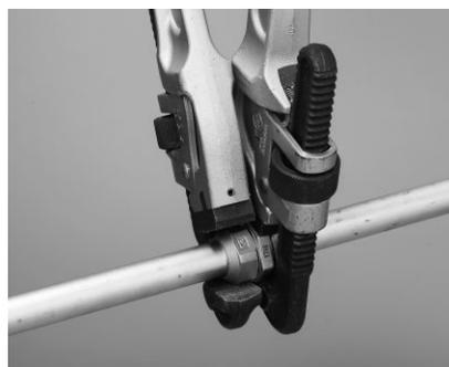
⚠️ **本締めの際には、必ず「継手本体」を固定して、「袋ナット」側を回してください。**
