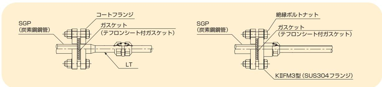
図2-10-1 絶縁フランジによる接合
