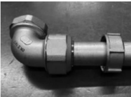
⑤ 変換ナットとパイプの間から、テーパリングの先端(紫)が見えていれば施工完了です。
