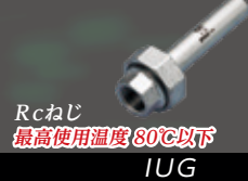
絶縁ユニオン (SGP用：マレアップルメッキ) 最高使用圧力 1.0MPa
